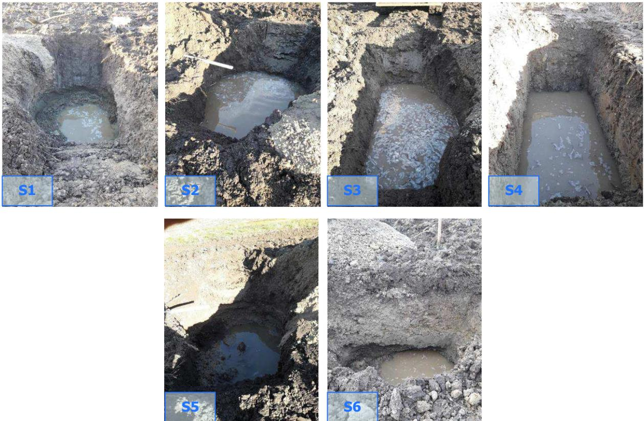
Les sols sont homogènes sur l'ensemble de la surface : ce sont des faciès quaternaires typiques des plaines alluviales du Rhin.
